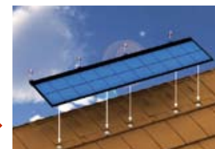
Exemple de la mise en œuvre de KoraSun® sur une toiture en tuiles Actua.
